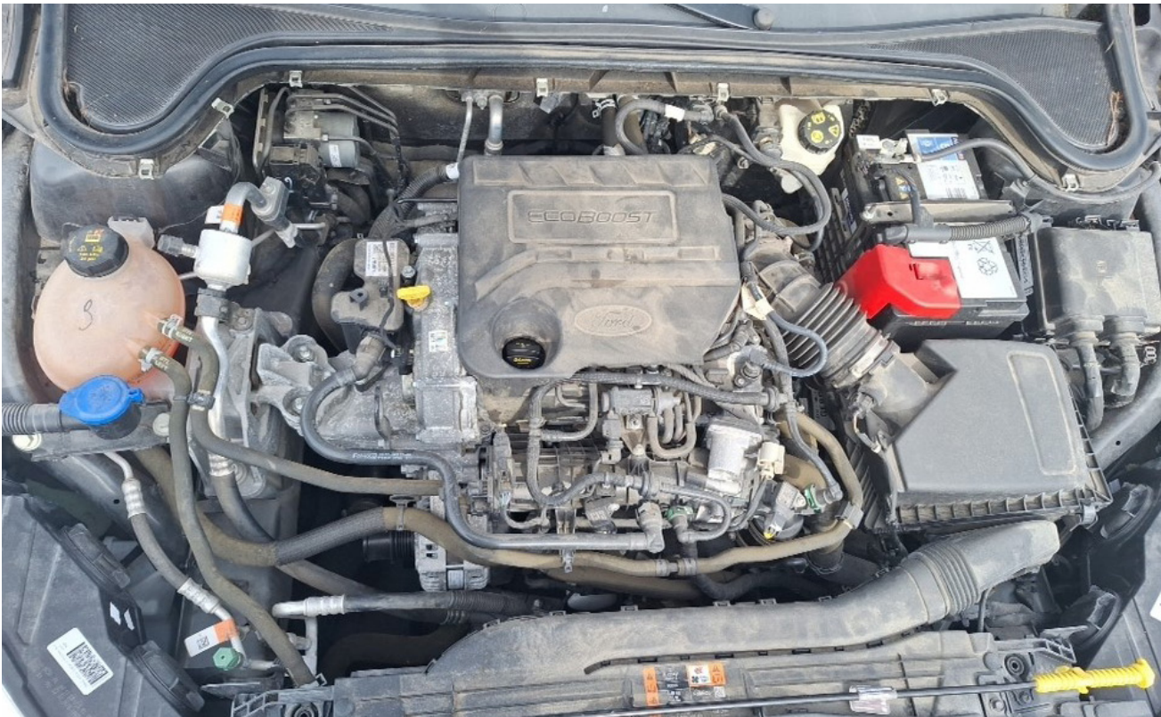
Un moteur 1.0 EcoBoost sur une Ford Focus tombée en panne à cause d'une dégradation de la courroie de distribution immergée dans l'huile. La voiture n'avait que 80 000 km au compteur. ©Photo transmise à Enquêtes d'actu
